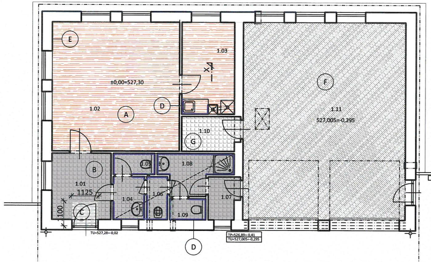
A Vinyl - dezén dřevo, rozměr 203,2 x 1524,0 mm
