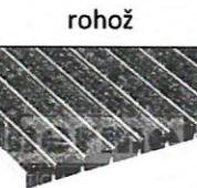
Hliníková rohož na hrubé nečistoty výška =22mm (hliníkové profily+textilní násady, barva antracit). Rohož volně vložena do hliníkového rámu. Rám se skládá z vany, roštu a odtoku. Rám výšky cca 69 mm zapustit do podlahy.
